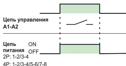
Обычно контактор используется для управления мощными нагрузками (освещение, вентиляция, обогрев). При этом он применяется в качестве управляемого устройства, а управляет его работой, например, термостат. Управление освещением может осуществляться с помощью датчика движения, сумеречного реле (реле освещенности) и т.д.
