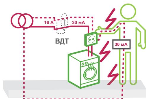
Измеряя разность силы тока между проводником под напряжением и нулевым проводником, дифференциальный выключатель нагрузки фактически обнаруживает ток, протекающий не по предусмотренной схеме нейтрали, в том числе через тело человека.
