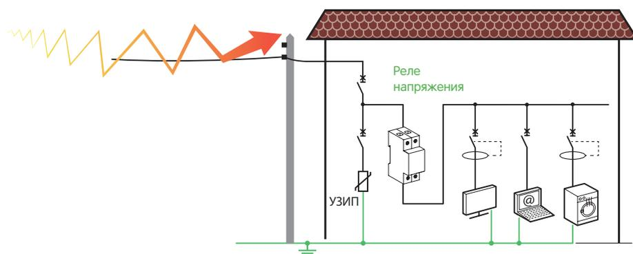
**+** При повышении или понижении напряжения реле Eazy9 автоматически отключает нагрузку. При нормализации напряжения в сети реле автоматически восстанавливает питание.
