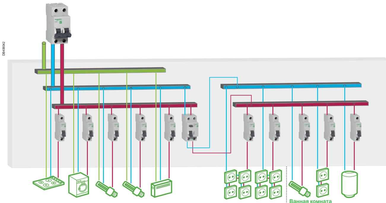
В соответствии с нормативными требованиями один выключатель дифференциального тока (ВДТ) может обеспечивать защиту всех розеток и всего электрооборудования в ванной комнате.
