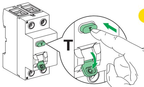
Тестирование аппарата один раз в месяц позволяет подтвердить его работоспособность. Исправный аппарат выключится и отключит напряжение.
